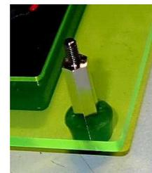
g) ナットドライバーで適度に締め付ける
