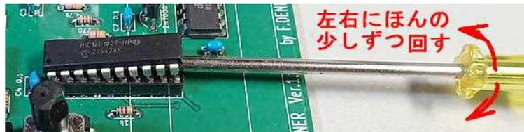
4. 3の操作を少しずつ繰り返し、マイナスドライバーの先が、PICの反対側から出るくらいまでにします。
