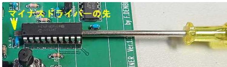
5. PICが強く斜めにならないように気を付けて、マイナスドライバーの柄を少し持ち上げたり(基板は固定)、柄を左右に更に少しずつ回していくと、PICが自然に抜けます。
